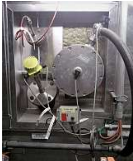
Die Druckluftimpulse werden im Pulsor selbst erzeugt, durch rückstromsichere Düsen ins Produkt geleitet und strömen dann entlang der Silowand.
